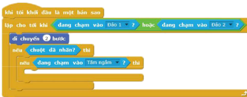
Hình 5.7.2. Kiểm tra xem Pháo có bắn trúng Tàu địch không
