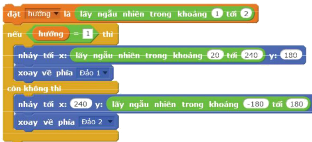
Hình 5.5.6. Đoạn khối lệnh hoàn chỉnh cho sự xuất hiện của Tàu địch
