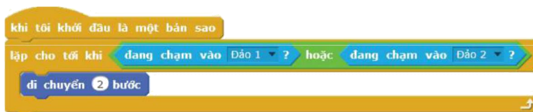
Hình 5.6.4. Đoạn khối lệnh điều khiển bản sao di chuyển
